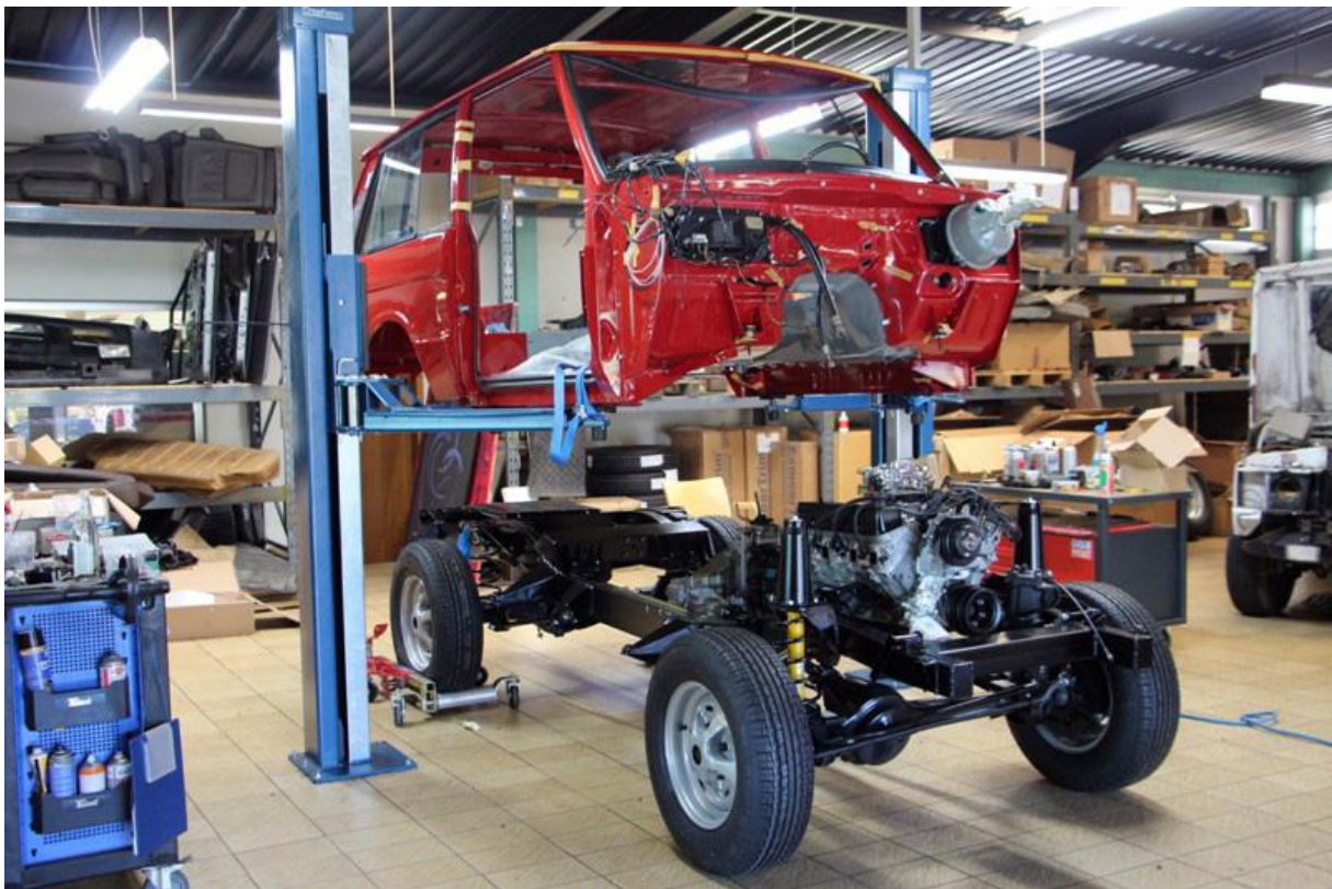
Karosserie nochmal kurz abgehoben um Motor und Getriebe ins Chassis zu setzen.
