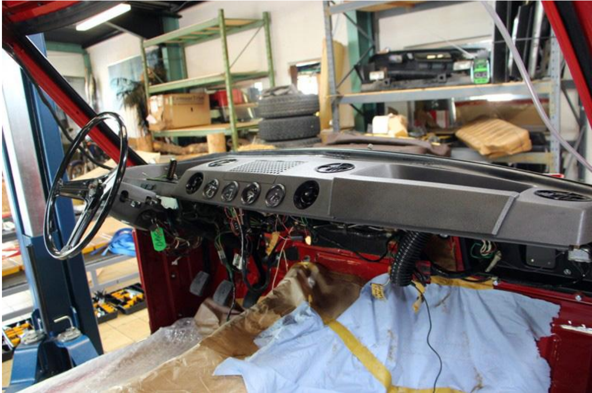
Das Klimaarmaturen Brett wird eingebaut.
