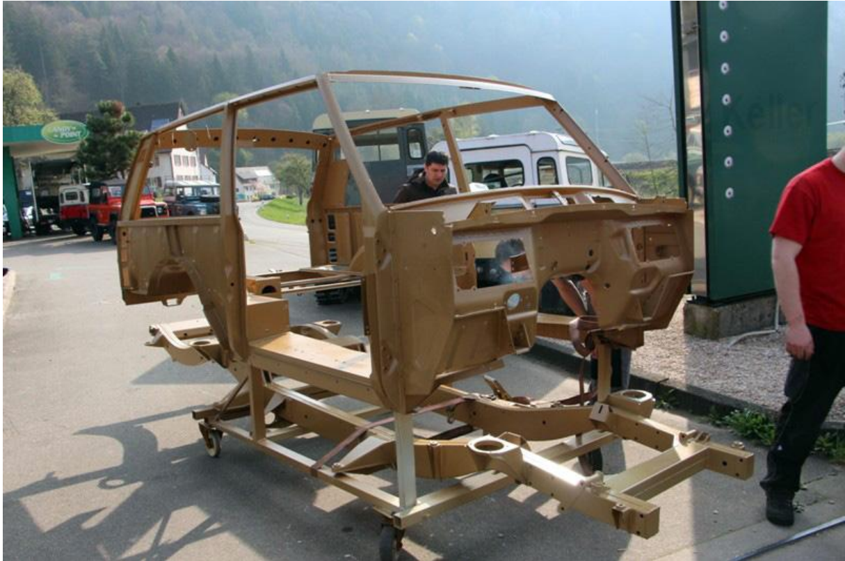
Die Karosserie nebst Anbauteilen ist zurück vom chemisch entlacken und KTL beschichten.
