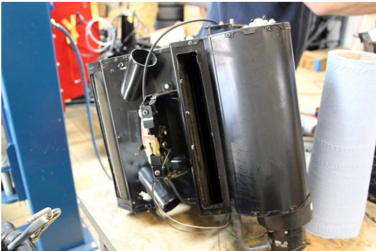
Überholung des Heizungskasten.
